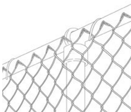
Poteau intermédiaire + tête support de lisse (Ø 48 ou 60 mm) + lisse tubulaire.
