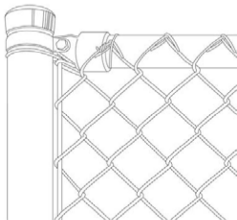
Poteau de début ou de fin + embout de lisse (= capuchon charnière Ø 42 mm, +collier = Ø du poteau d'angle -> à déterminer + boulon) + lisse tubulaire
